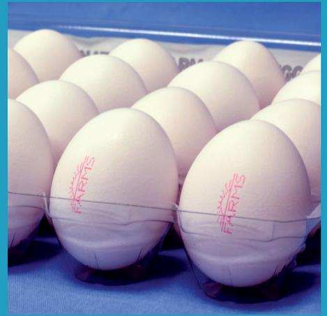
En los equipos de clasificación modernos de alta capacidad, pasarán un total de 10 huevos delante de un cabezal de impresión cada segundo. Puesto que cada huevo puede destinarse a cualquier vía de envasado, puede imprimirse con cualquier código.
